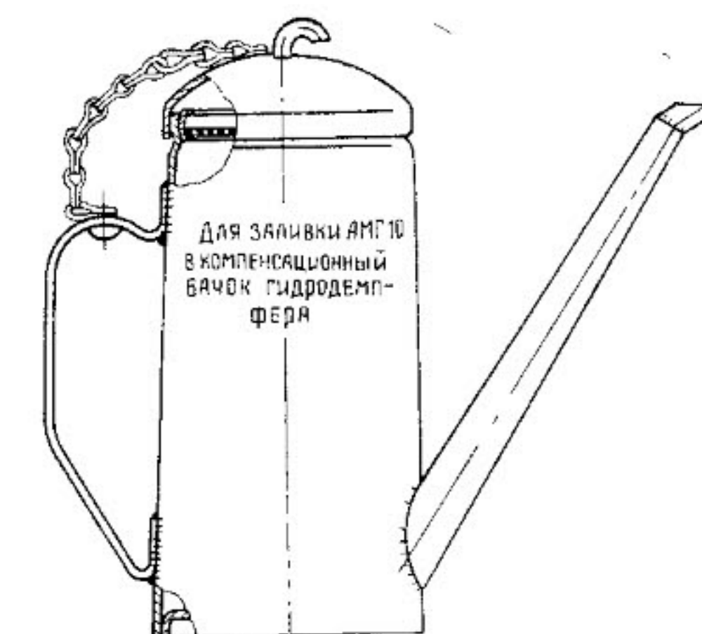
Рис. 150. Чайник для заливки масла АМГ-10 в компенсационный бачок гидродемпфера
