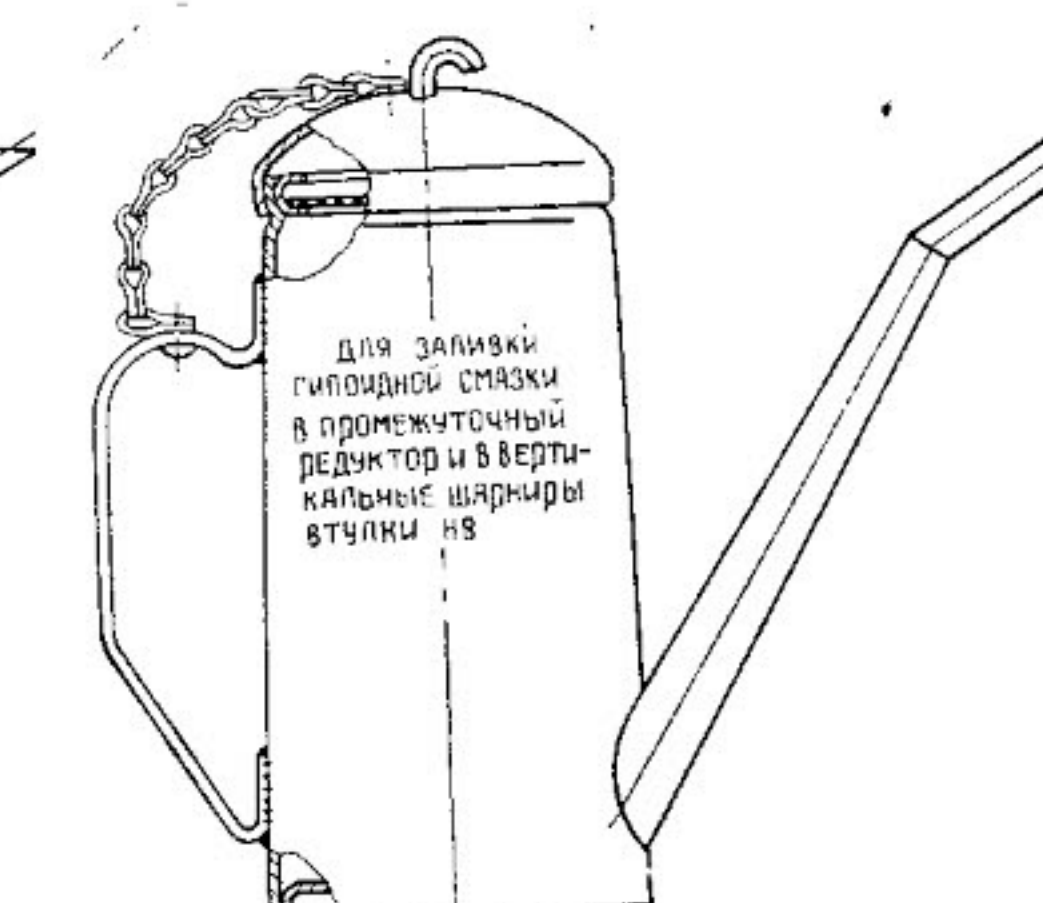
Рис. 151. Чайник для заливки гипоидной смазки в промежуточный редуктор и в вертикальные шарниры втулки несущего винта
